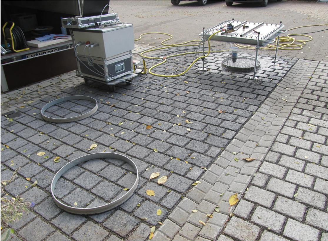
**Foto 2: Infiltrationsmessgerät Versuchsdurchführung**
